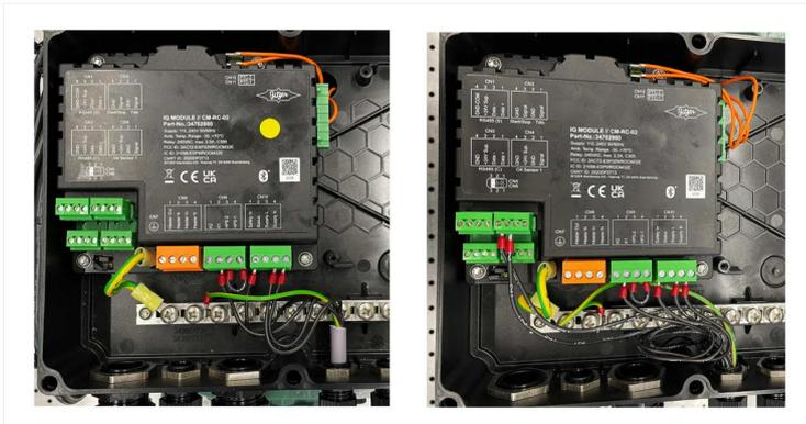
CM-RC-02 im Schutzmodus (links) und Verdichterbetriebsmodus (rechts)
