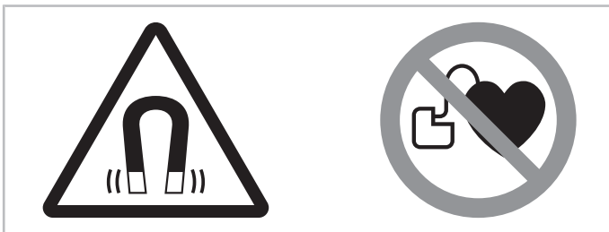
Abb. 15: Warn- und Verbotsschilder auf einem Verdichter mit LSPM-Motor
