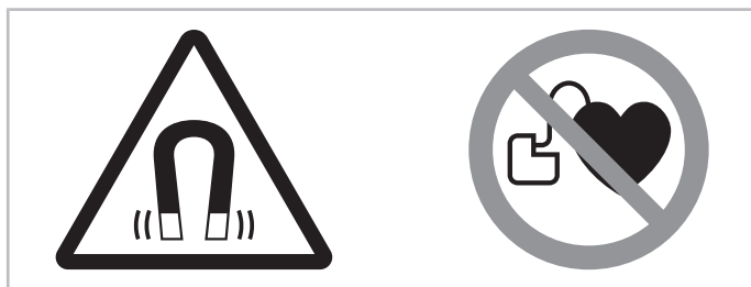
Рис. 12: Предупреждающие и запрещающие знаки на компрессоре с LSPM мотором
