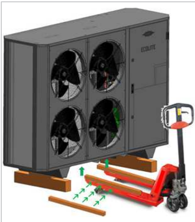
Abb. 8: Anheben mit Gabelstapler
