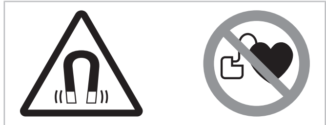
Abb. 8: Warn- und Verbotsschilder auf einem Verdichter mit Permanentmagnetmotor
