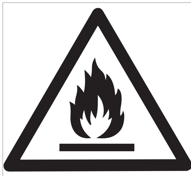
Fig. 1: Symbole de danger « Danger matières inflammables » (ISO7010 W021)
