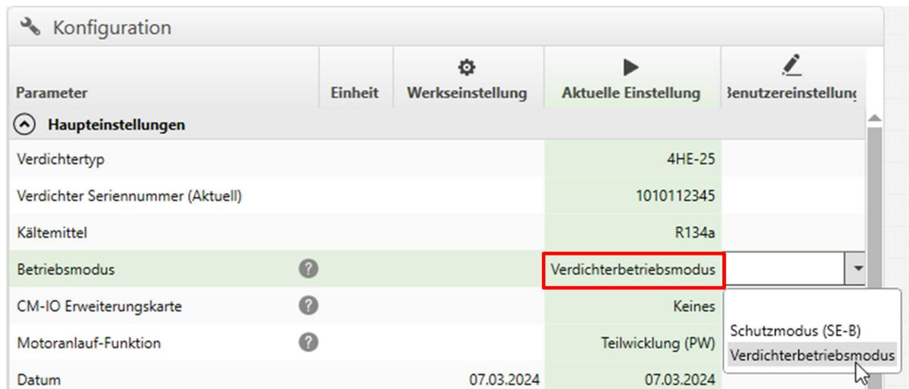
Danach können die anderen Parameter unter dem Menü "Main Setup" konfiguriert werden. Das Modul ist werkseitig mit der Seriennummer des Verdichters, dem Verdichtertyp, dem Standardkältemittel und der Motorstarterfunktion vorprogrammiert.
